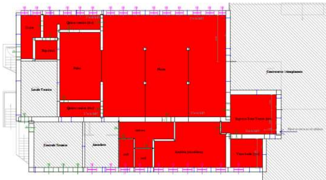
Figura 7 : Planimetria degli ambienti riscaldati (in rosso) presenti al piano seminterrato
